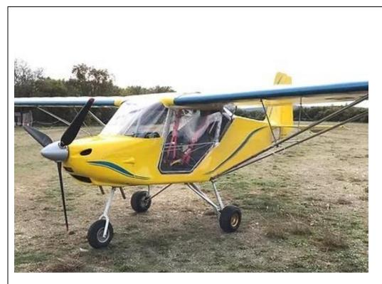
L'appareil utilisé pour la formation est un « Nynja », ULM de la catégorie « 3 axes » : il se pilote exactement comme un avion dont il ne diffère que par son poids (280 kg à vide) .
