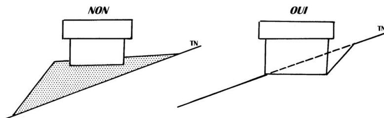
Les terrassements doivent être limités au maximum. Tout terrassement en remblai destiné à créer une plate-forme géométrique autour de la construction est interdit. Il sera privilégié des terrassements en décaissement.
